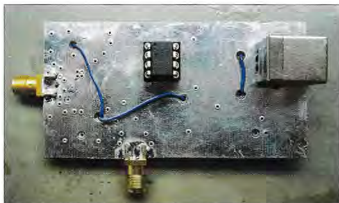
Bild 2: Oberseite der Vorteilerleiterplatte mit den wenigen Drahtbrücken, dem ATtiny45 und der USB-Buchse
