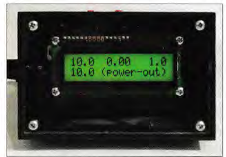
Bild 6: SWV-/Leistungsmesser, Anzeigewert 10 W PEP Fotos: DC4KU
