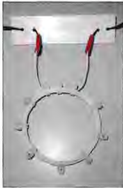
Bild 3: Die Luftspule sollte eine Zugentlastung erhalten, hier in Form eines Kunststoffstreifens mit Bohrungen. Fotos: DL3MGK
