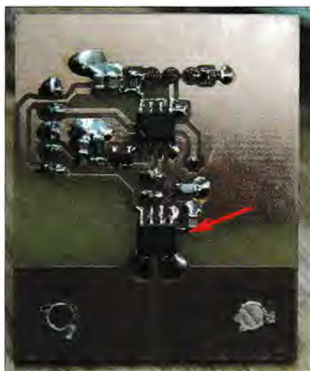
Bild 7: Bestückte Unterseite der Strommessplatine mit dem SMD-Schaltkreis ACS714 ELCTR-30A-T
