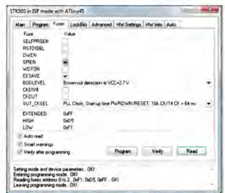
Bild 2: Konfiguration der Fuse-Bits für die Programmierung
