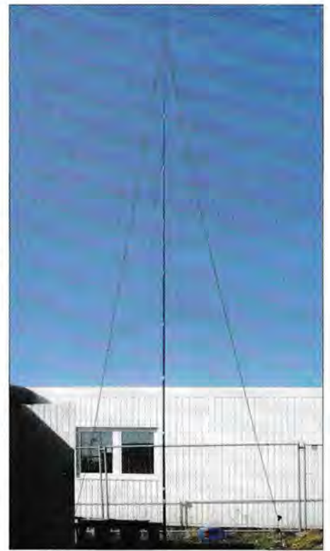
Bild 2: Fertig aufgebaute Vertikalantenne am Standort von DL0EIC
