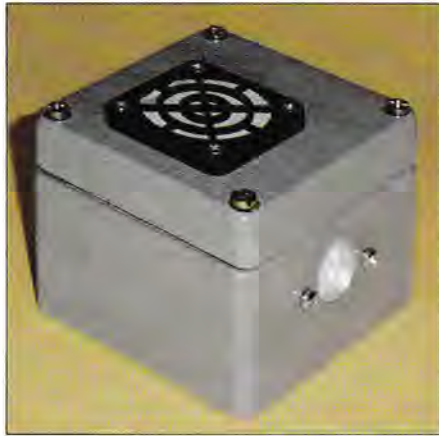
Bild 7: Für die Sensorbaugruppe kommt ein Aluminiumdruckgussgehäuse zum Einsatz; spezielle PTFE-Filter schützen den Sensor vor Feinstaub und Wasser.
