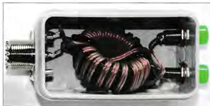
Bild 3: Direkter Anschluss des Eigenbau-Baluns an ein Antennenanpassgerät LDG AT-100 Pro II
