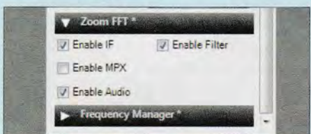
Bild 12: Häkchen im Menüfeld Zoom FFT zur Anzeige des ZF (IF)- und Audio-Spektrums
