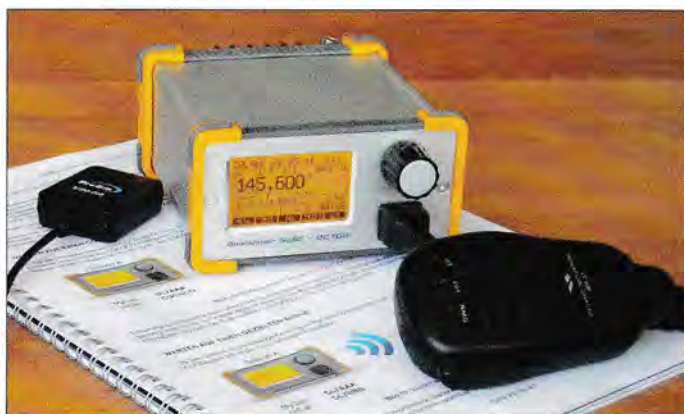
Bild 2: Die Baugruppen des STT-Transceivers SuSE sind auf vier Platinen untergebracht, 2-m-Sender-Empfänger, STT-Shield sowie Controller- und LCD-Platine.
