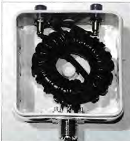
Bild 1: Der Balun mit Netz-Zwillingslitze ist für mittlere Sendeleistungen geeignet.
