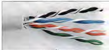
Bild 4: Ein Netzwerkkabel enthält vier verdrehte Doppeladern, die bis weit über 100 MHz hinaus definierte Eigenschaften haben.
