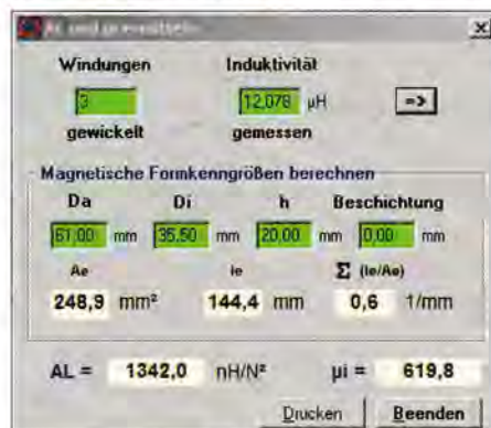
Bild 2: Berechnungs-Tool für die Ermittlung von A_L und \mu_i bei unbekanntem Kern
