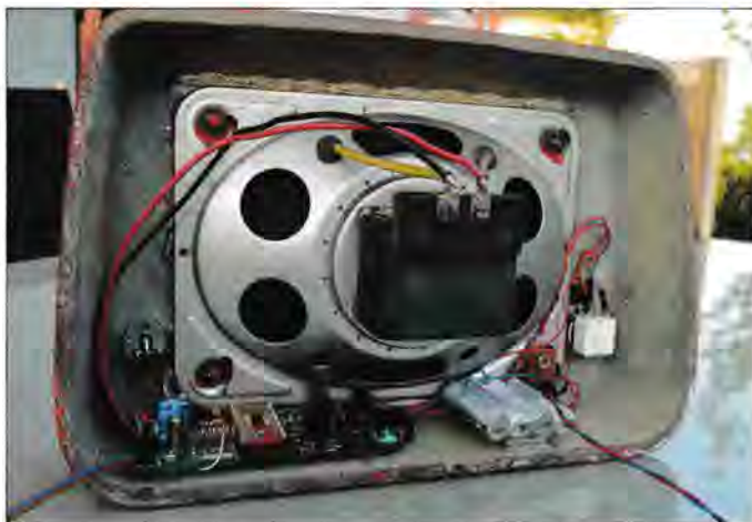
Bild 4: Innenaufbau des UKW-Radios; der große Lautsprecher sorgt für einen guten Klang, rechts unten sind die NiMH-Akkumulatoren der Stromversorgung zu erkennen.
