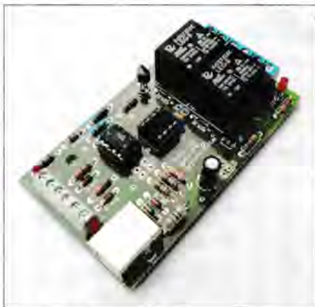
Bild 1: Die komplett bestückte Relaisbaugruppe passt in ein Hutschienengehäuse.
