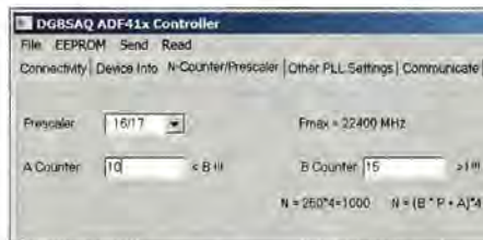
Bild 14: Reiter N-Counter/Prescaler ; im Beispiel wurde ein Teilverhältnis von N = 1000 eingestellt.
