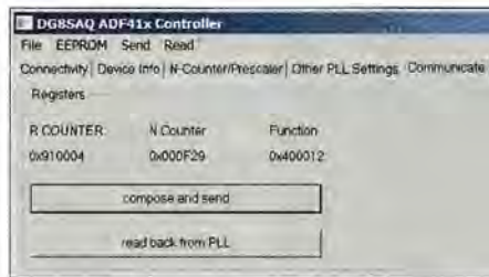
Bild 15: Im Reiter Communicate ist das Beschreiben und Auslesen des PLL-Schaltkreises möglich.
