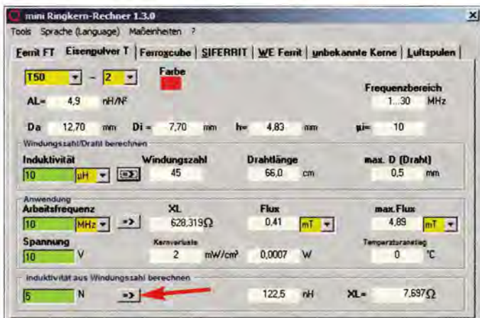
Bild 1: Berechnungskarte für Eisenpulver-Ringkern (T...-...) von Amidon, die Kernfarbe ist ebenfalls sichtbar; neu ist der hier durch einen Pfeil markierte Go-Button zum Auslösen der Berechnung. Screenshots: DG0KW
