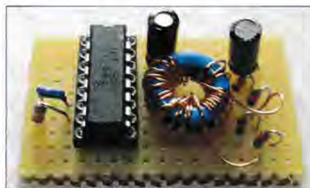
Bild 1: Musteraufbau des Spannungswandlers auf einer Universalleiterplatte
